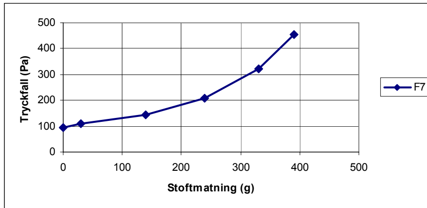
Figur 2 Exempel på tryckfallsutveckling för ett F7-filter testat enligt SS EN 779.
